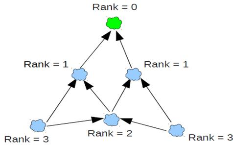
Fig. 3. DODAG Smart Meter Nodes with Ranks[36]
